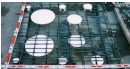
写真-1 欠陥配置状況
