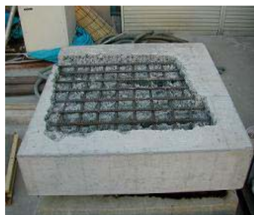
写真 - 1 吹付け性状確認供試体
