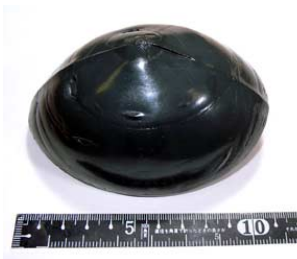
写真－1 廃プラスチック塊（中間材料）
