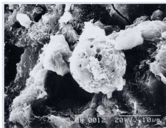
写真－２ フライアッシュ周囲の反応生成物
