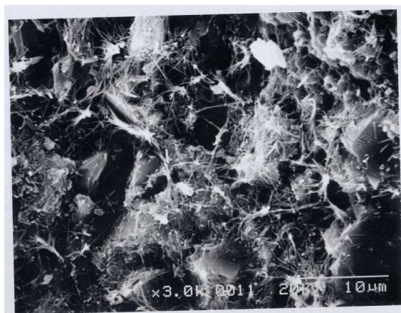
写真－１ 瓦廃材微粉末周囲の反応生成物
