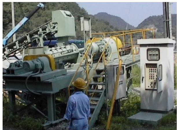
写真 - 2 スクリー摩砕法装置
