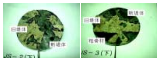
打継部 - 2 打継部 - 3 写真 - 3 打継部せん断供試体の破断面
