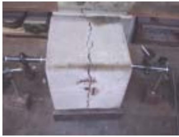
写真-1 プレーン破壊状況
