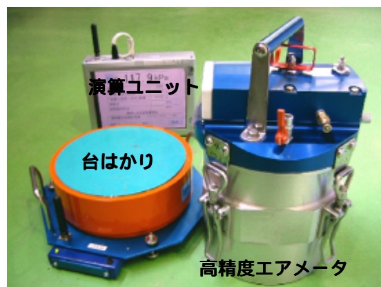
写真-1 単位水量測定装置
