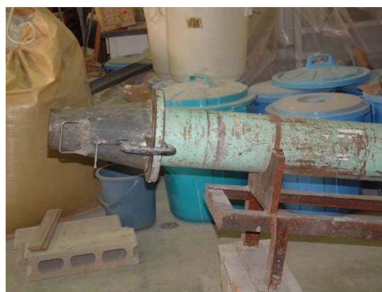
写真－２ スランプコーン取付状況
