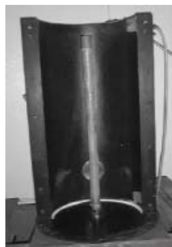
写真 - 1 排水管設置状況（室内試験）
