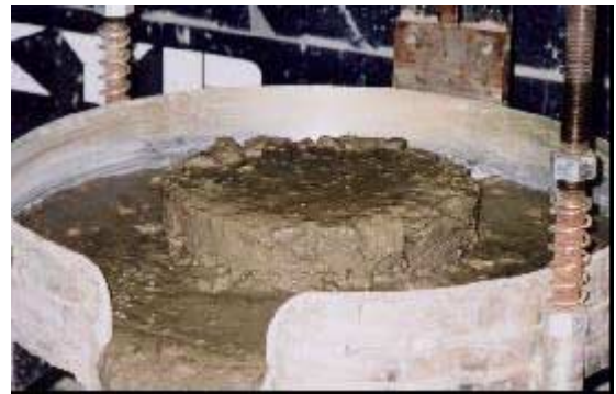
図－3 障害装置内の堆積状況の一例
