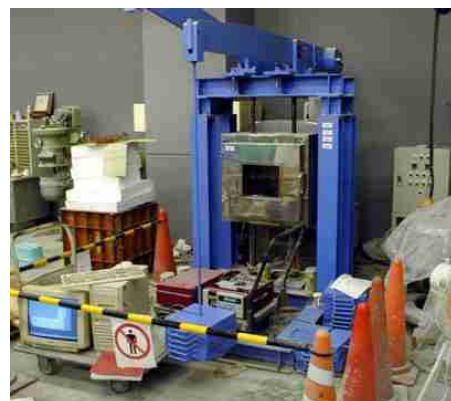
写真—2 てこ式クリープ試験機
