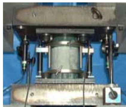
写真-1 直接引張試験状況
