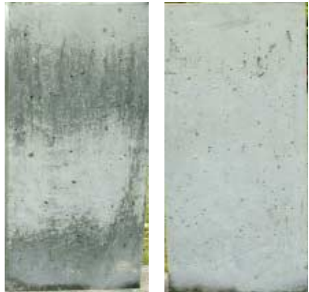
写真-6 界面活性剤 Sa10 の有無による頁岩砕砂使用コンクリート肌面の違い(図 Sa10 無添加, 右 Sa10 0.130\text{kg}/\text{m}^3 添加)
