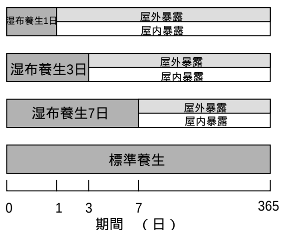
図-1 養生条件および暴露環境
