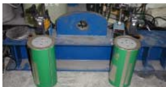
写真-1 レーザー変位計による沈降の計測
