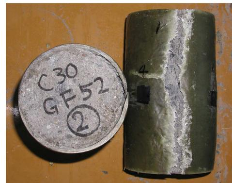
写真 - 7 供試体破壊状況
