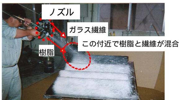
写真 - 1 SFRP 吹付け状況
