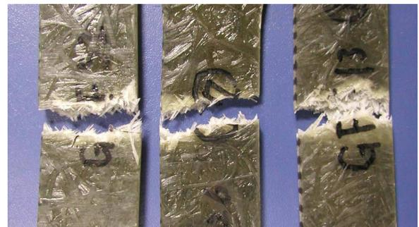
写真 - 3 SFRP 破断面
