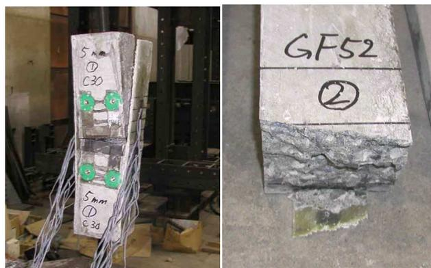
写真 - 5 付着せん断試験破壊状況 写真 - 6 曲げ試験破壊状況
