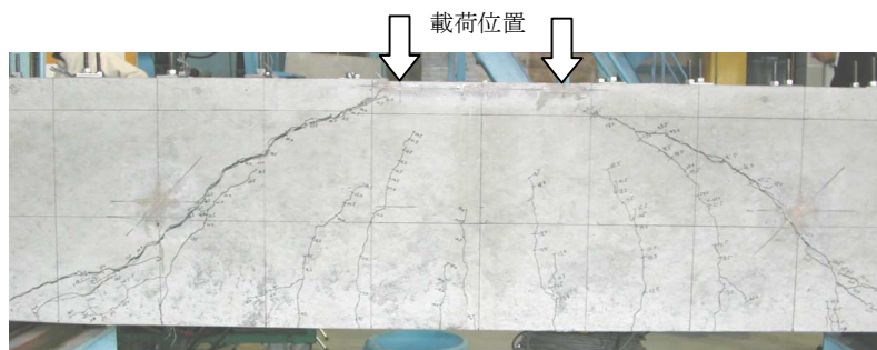
写真－２ 供試体破壊状況（No. 4 供試体）
