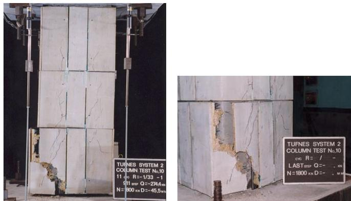
写真 - 1 No.10最終破壊状況
