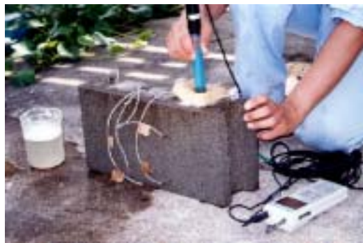
写真 - 2 自然電位の測定
