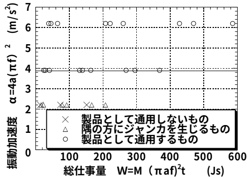
図－４ 振動加速度，総仕事量と締固め結果の 関係（スランプ 18 ± 2.5cm）
