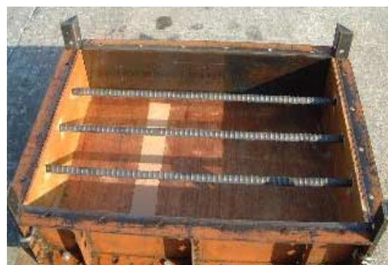
写真—1 スラブ型枠供試体
