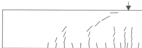
図-1-3 軸方向鉄筋比 1.33%のひび割れ図
