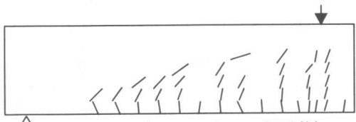
図-9 ひび割れ図 (No. 1 供試体)
