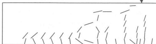
図-1-4 軸方向鉄筋比 2.0%のひび割れ図
