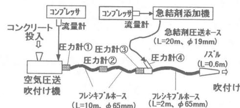
図-6 空気圧送方式の配管と圧力測定位置
