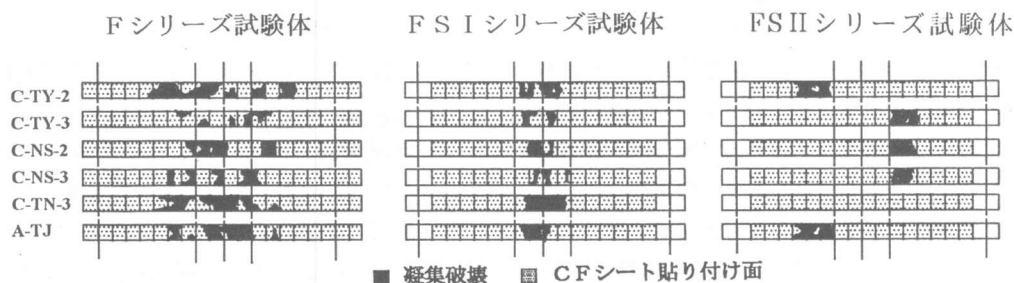
図-5 曲げ試験による引張側底面の破壊状況図
