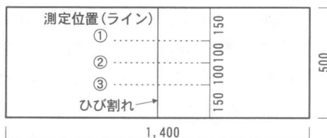
図-6 人工ひび割れ無筋試験体の計測ライン
