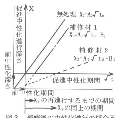
図3 補修後の中性化進行の概念図
