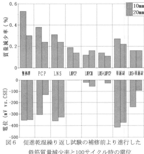
図6 促進乾湿繰り返し試験の補修前より進行した
