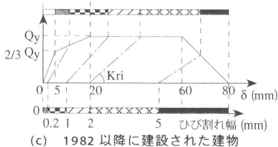
図12 建設年別建物の応答モデル
