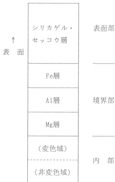
図-5 強酸により劣化したセメントペーストの構造
