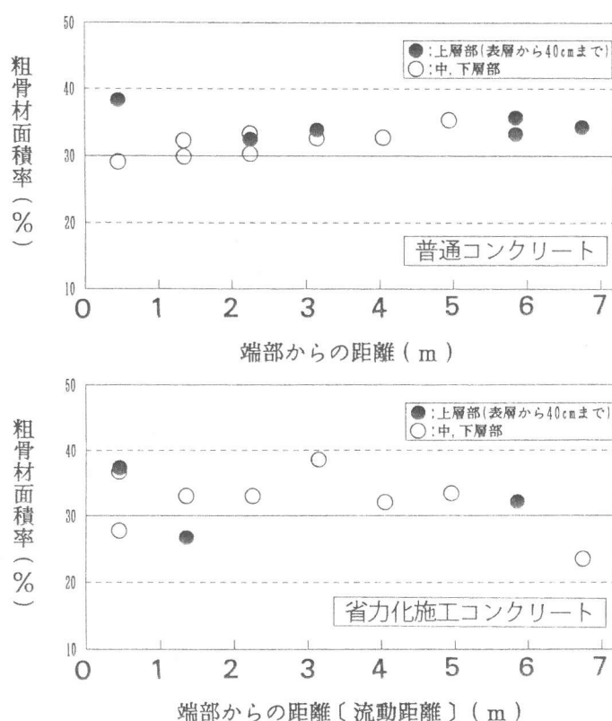
図-7 採取コア側面から求めた粗骨材面積率
