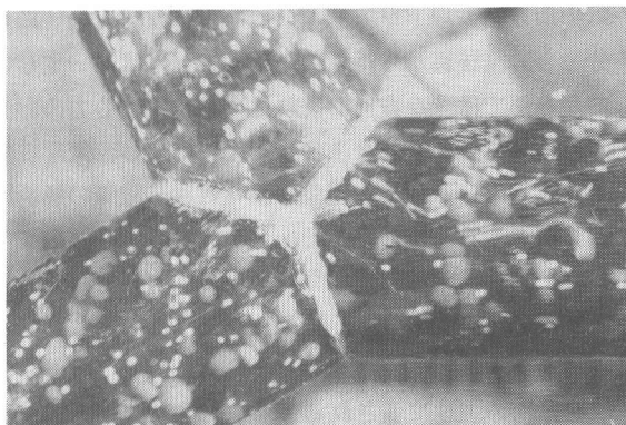
写真-2 非対象分岐管での閉塞過程
