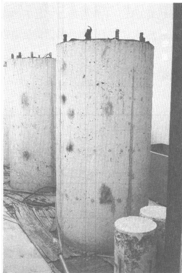
写真-3 フライアッシュ(籾)と高炉スラグセメント(飴)を用いた供試体(ひびわれなし)
