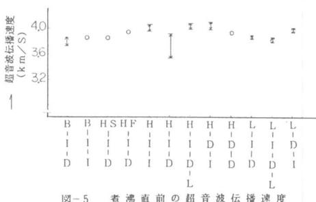
図-5 煮沸直前の超音波伝播速度
