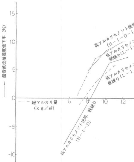
図-3 総アルカリ量と超音波伝播速度低下率の関係
