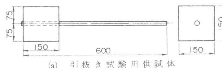
(a) 引抜き試験用供試体
