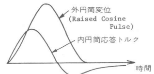
図-2 Raised Cosine Pulse および応答トルク
